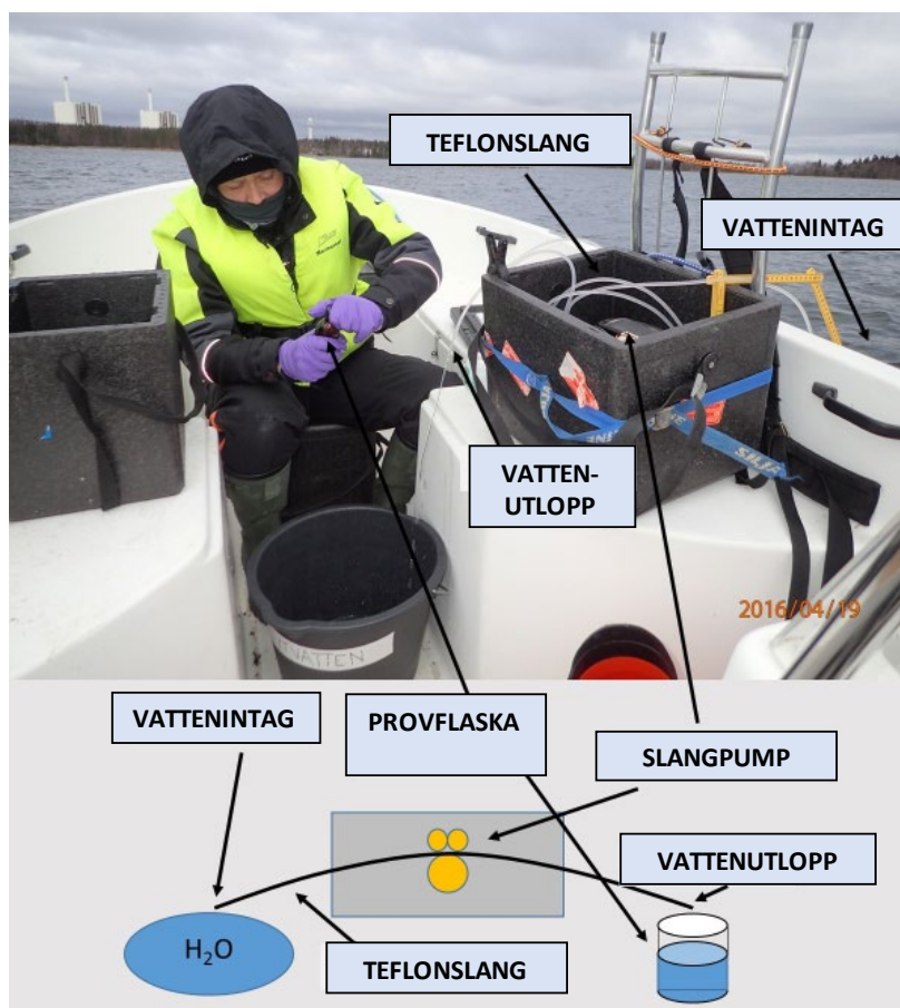
Figur 3-3. Vårprovtagning av ytvatten med slangpump på en havspunkt. Under fotografiet visas en schematisk bild av pumpenheten.
