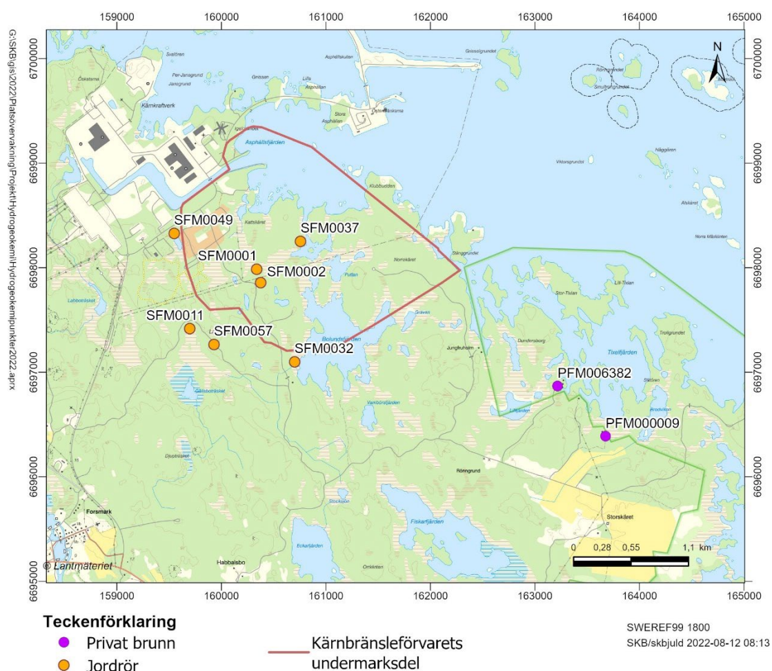
Figur 2-2. De sju jordrören placering i undersökningsområdet och de privata brunnarna i förhållande till området för det planerade kärnbränsleförvarets undermarksdel.
