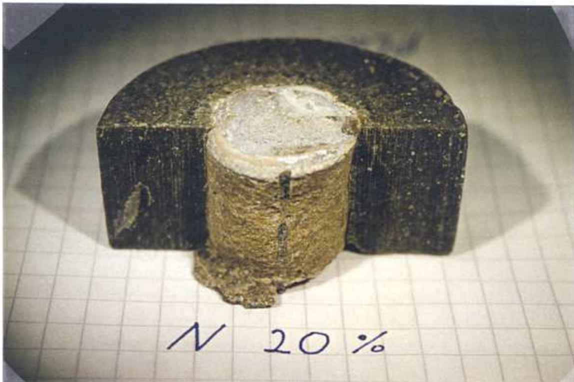
Figur 5.3. Betong/bentonit med ingående vattenkvot 20 %
