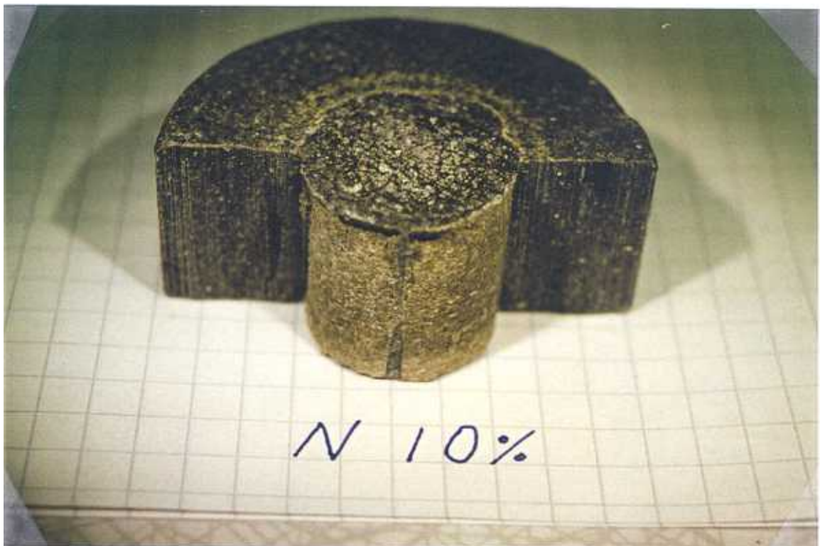
Figur 5.1. Betong/bentonit med ingående vattenkvot 10 %
