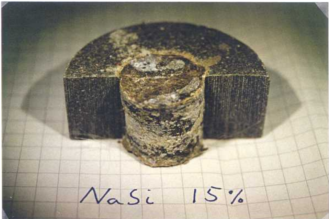
Figur 5.5. NaSi mellan betong/bentonit med ingående vattenkvot 15 %
