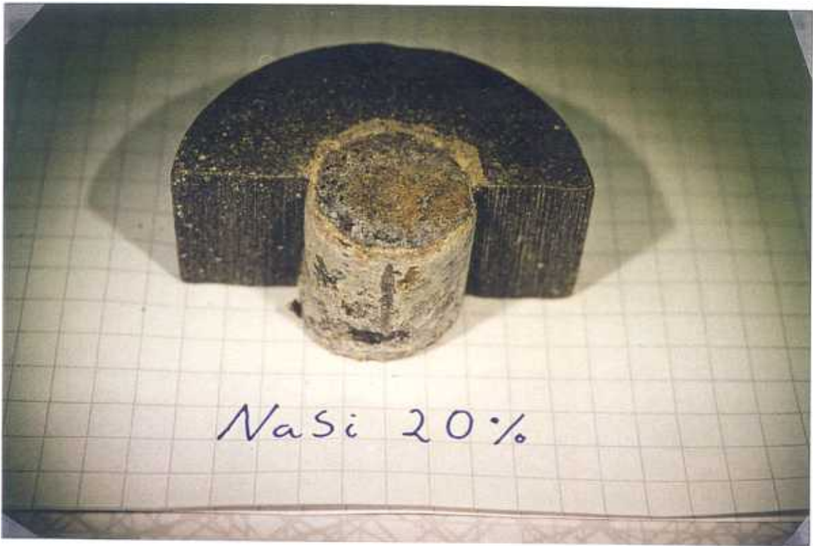
Figur 5.6. NaSi mellan betong/bentonit med ingående vattenkvot 20 %
