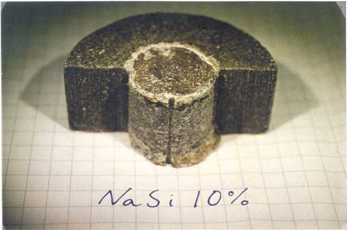
Figur 5.4. NaSi mellan betong/bentonit med ingående vattenkvot 10 %
