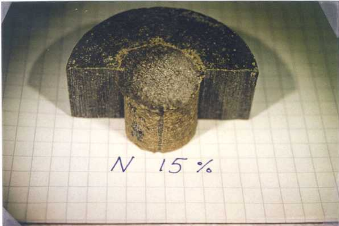
Figur 5.2. Betong/bentonit med ingående vattenkvot 15 %
