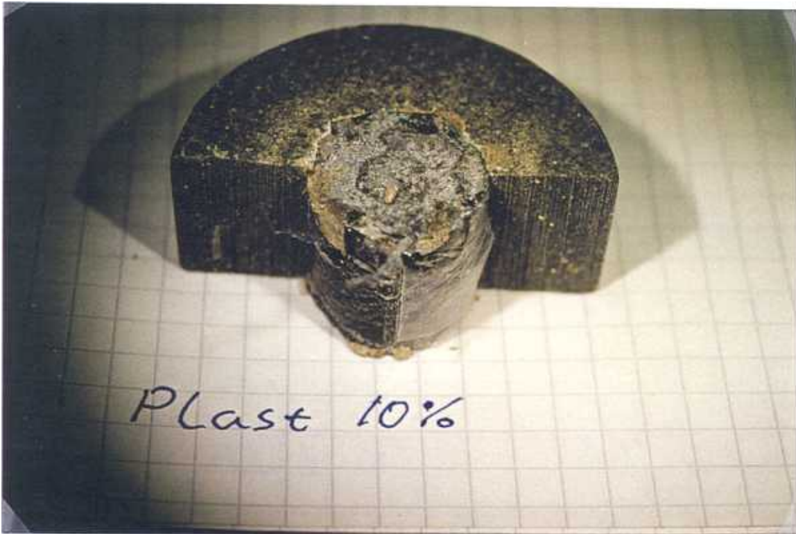
Figur 5.7. Plast mellan betong/bentonit med ingående vattenkvot 10 %
